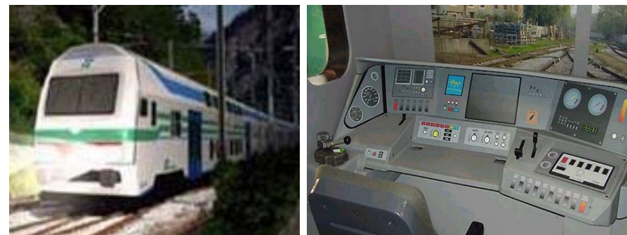
Carrozza semipilota e relativa cabina di guida - Pasaĝervagono kun stirejo ekstere kaj interne
