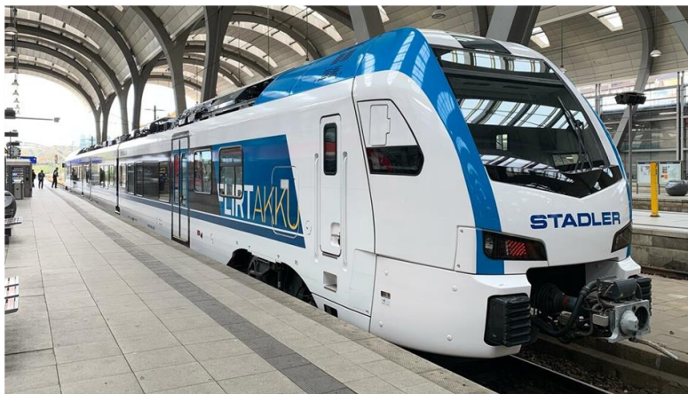
Fig. 6: Elektra traktio nutrita alternative el kontaktlineo aŭ akumulatoro ( Stadler )
